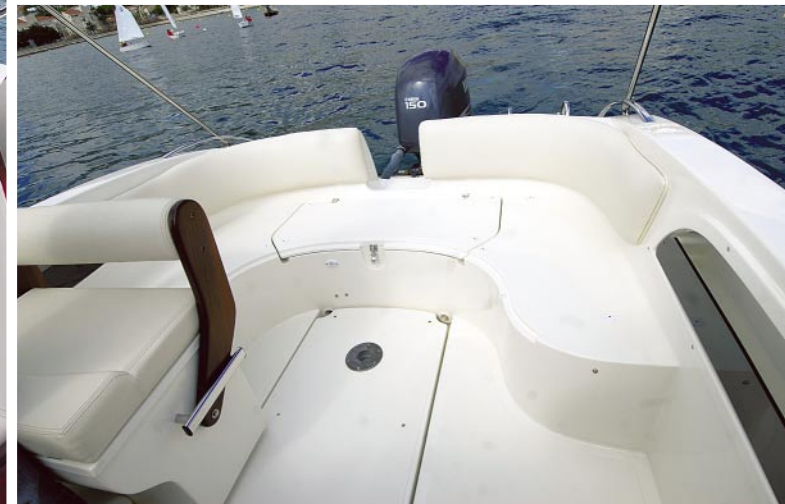
Eolo 590 Day ima neprekinutu krmenu klupu s unutarnjim spremnikom, a na krmi se prolazi kroz prekid na naslonu klupe; pramčana kabinica je nešto manja nego u 650-ici, dovoljno je velika za dva ležaja i veliki spremišni prostor unutar i između njih
