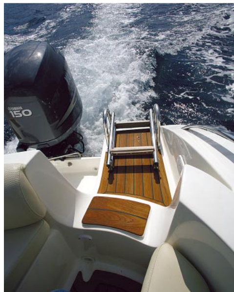
Eolo 650 Day ima prolaz s krme koji je kao i pod u kokpitu pokriven tikovinom, prolaz prema pramčanoj palubi je na lijevoj strani, a u pramčanoj kabinici je dvojni ležaj s velikim spremišnim prostorom ispod
